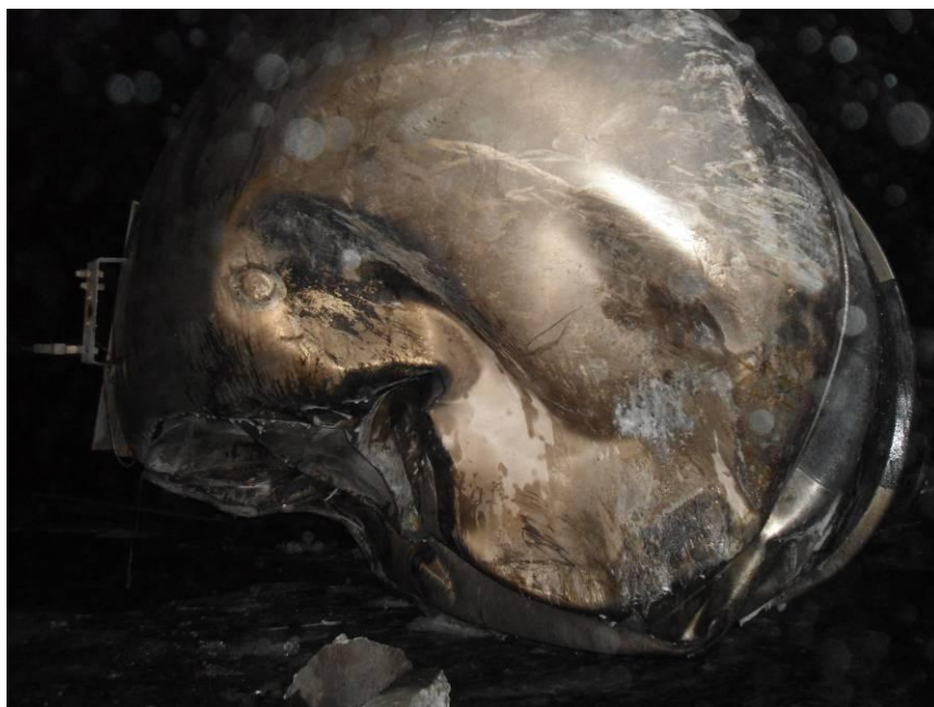
Imagem 18 – amolgaduras verificadas na região anterior do tanque de V1B .
