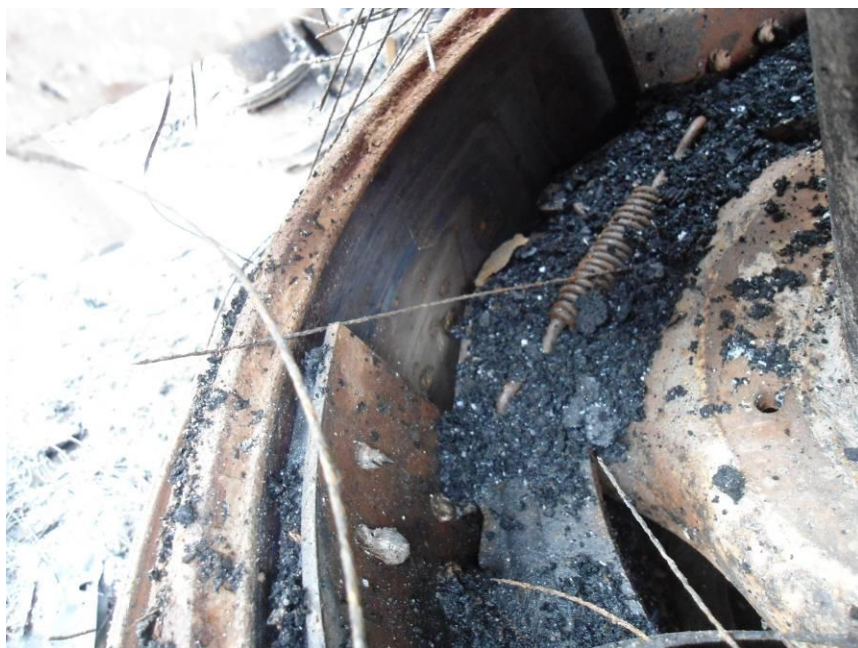
Imagem 22 – vista parcial do tambor e guarnições de freio de terceiro eixo de V1B .
