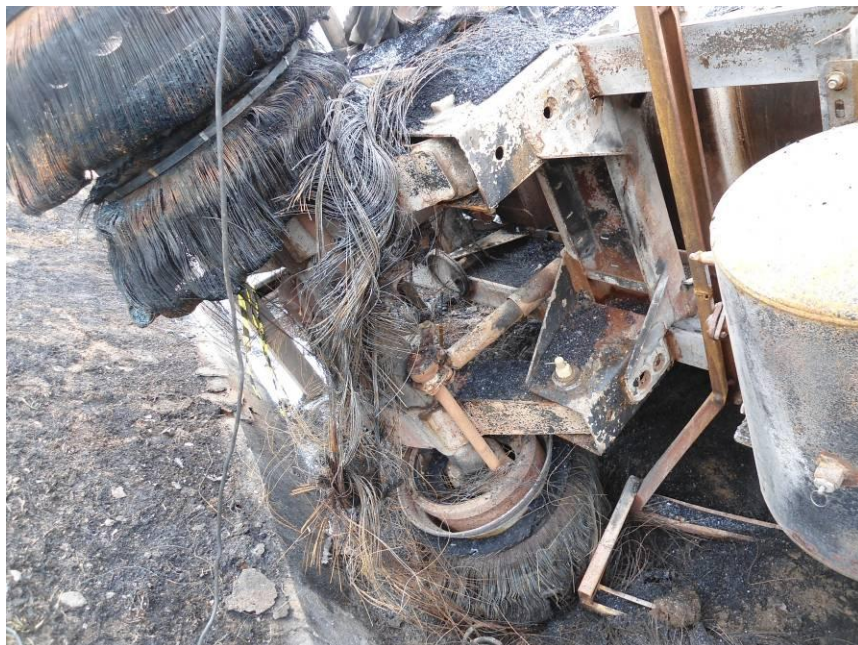
Imagem 21 – situação do sistema de freios e suspensão após o acidente de V1B .
