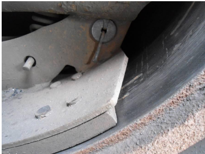
Imagem 13 – vista parcial do tambor e guarnições de freio de uma das rodas preservadas de V1A .
