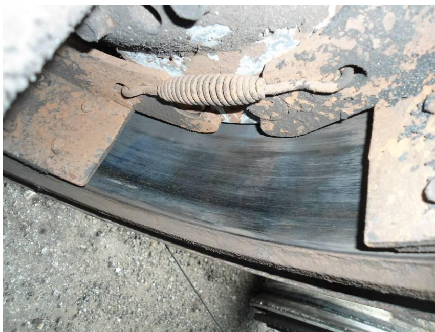
Imagem 14 – detalhe da coloração azulada da pista de frenagem do sistema freios de V1A .
