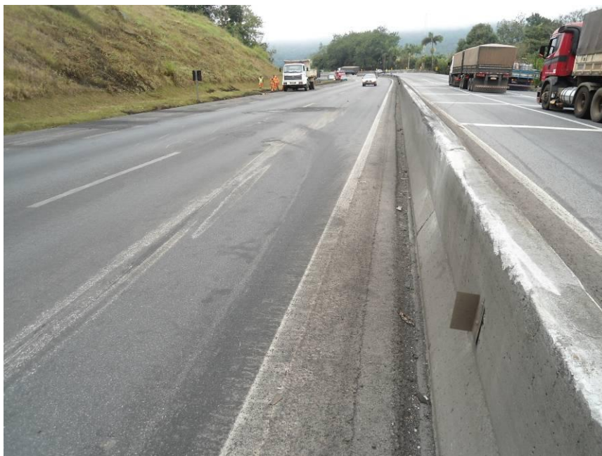
Imagem 75 – vista diurna dos sulcos e marcas de atrito sobre o leito asfáltico contíguos às marcas do rodado de V1B na pista de fluxo oposto.
