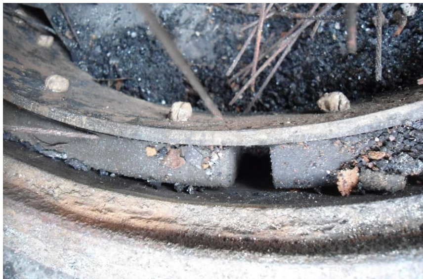
Imagem 23 – vista parcial do tambor e guarnições de freio do rodado de V1B .
