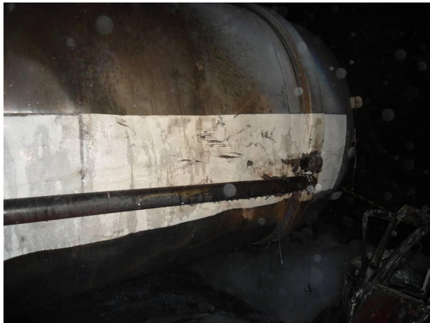
Imagem 20 – amolgaduras na região superior, terço posterior do tanque de V1B .
