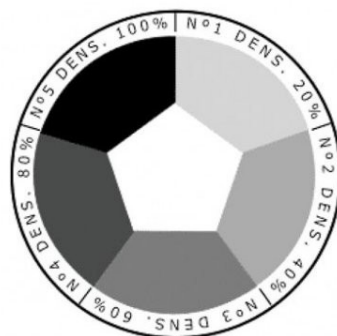
Figura 1: Escala de Ringelmann para caracterização da coloração de fumaças de combustão.
