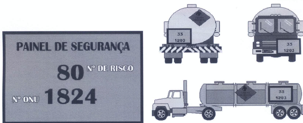
Figura 01. Painel de Segurança com Numero ONU; e Figura 02. Localização do Painel de Segurança no caminhão.
