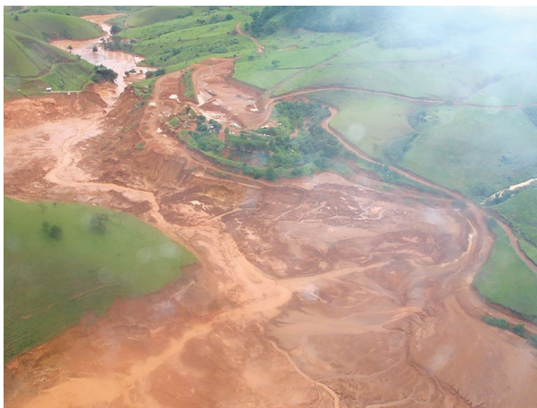
Figura 3.41. Barragem de rejeitos de bauxita que rompeu em 2007, no município de Mirai, causando graves danos ambientais e patrimoniais.
